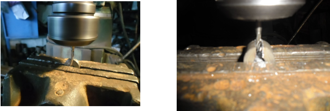
Figura 14 y 15. Elaboración de ranuras de las pesas
