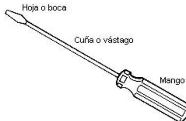
El mango para sujetar el destornillador se fabrica de distintos materiales de tipo blando como son la madera, las resinas plásticas, entre otros; que facilitan su manejo y evitan que resbalen al efectuar el movimiento rotativo de ajuste o desajuste, además de servir para lograr un aislamiento de la corriente eléctrica
