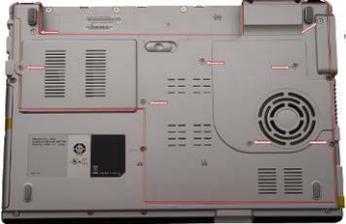
Una ilustración técnica de la parte inferior de un portátil. Se muestran ocho tornillos rojos que se deben instalar en la tapa inferior. El diagrama incluye líneas rojas que indican la posición exacta de cada tornillo. En la esquina superior derecha del diagrama se encuentra el texto 'Fig. 11'. |
