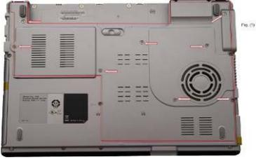
Una ilustración de la tapa inferior de un equipo electrónico. Se muestran ocho tornillos que deben ser colocados en la tapa, indicados por líneas rojas que conectan los tornillos con los puntos de montaje en la tapa. El equipo tiene un ventilador circular a la derecha y un puerto de acceso a la izquierda. |
