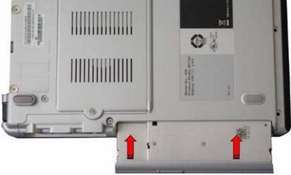
Una fotografía de la parte posterior de un equipo electrónico. Se muestra la unidad óptica instalada en su compartimento. Dos tornillos de cabeza plana están sujetos a la parte inferior de la unidad, asegurándola al chasis. Dos flechas rojas apuntan hacia arriba desde los tornillos, indicando su posición. |
