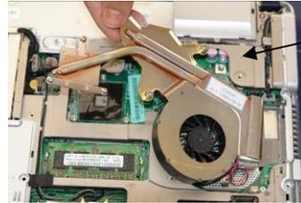
Extractor/disipador de calor para computadores portátiles.
